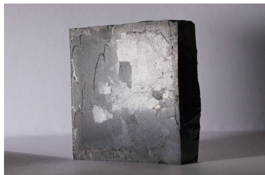
图2 高温超导样品钇钡铜氧(YBaCuO) [3] 。这是第一类达到液氮温区的超导体。高温超导的机制仍然是当今凝聚态物理研究的核心问题
